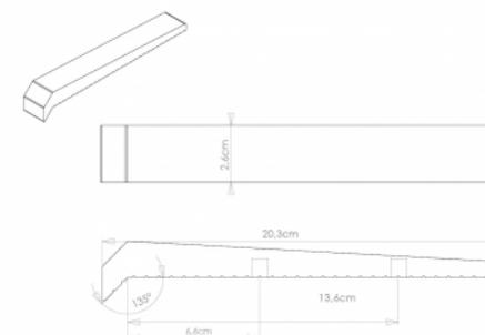
Cette pièce en aluminium extrudé est conçue pour les murs avec un rayon de 0 cm à 0,9525cm. Cette pièce est fixée avec 2 douilles de fixation
