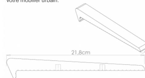
Cette pièce en aluminium extrudé est conçue pour les murs avec un rayon de 0 cm à 0,9525cm. Cette pièce est fixer avec 2 douilles de fixation
